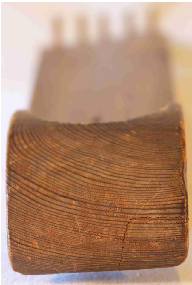
Ponnen kärjessä, pitkän sivun puolella, on L-kirjaimen muotoinen murtuma. Ponnen päällä näkyvät puun vuosirenkaat voimakkaana kuviointina ja alapuolella näkyy puun ydin.
