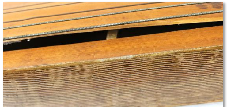
Läbellä kannen pitkää sivua on suuri halkeama, josta kansilevy on pullistunut auki. Aukosta näkyy kaksi kansirimaa.
