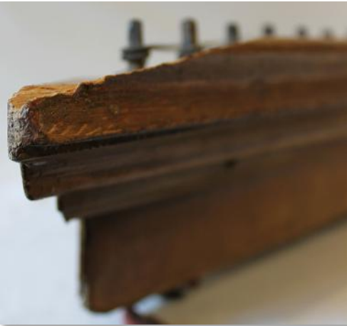
Viritystappien suojan kärjestä on lohjennut pala pois.
