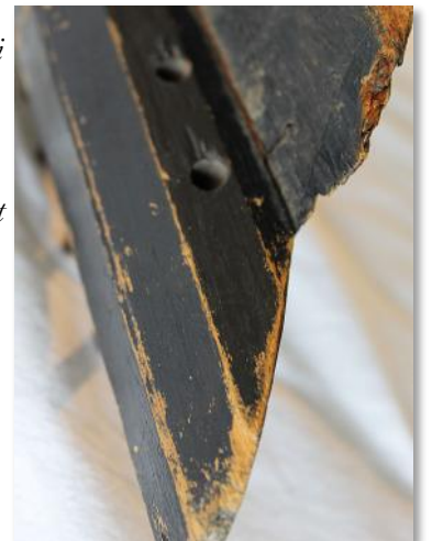
Viritystappipenkki on muotoiltu viistoamalla.
