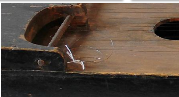
Kaikki kielet ovat noin 0,25–0,26 paksuista teröslankaa, mikä (useiden erilaisten silmukoiden käytön lisäksi) antaa olettaa, että kielet on vaihdettu jossain vaiheessa sellaisen toimesta, jolla ei ole ollut kokemusta kanteleiden kielityksestä. Pisin kieli on katkennut ja se on sidottu langalla kiepille.
