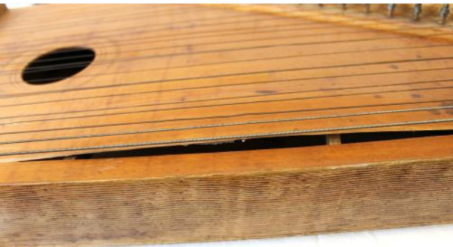
Läbellä kannen pitkää sivua on suuri halkeama, josta kansilevy on pullistunut auki. Aukosta näkyy kaksi kansirimaa.
