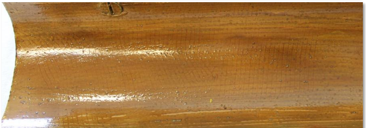
Myös ponnen alapinnalla näkyy, vaikkakin heikosti, terävällä esineellä vedettyjä juovia.
