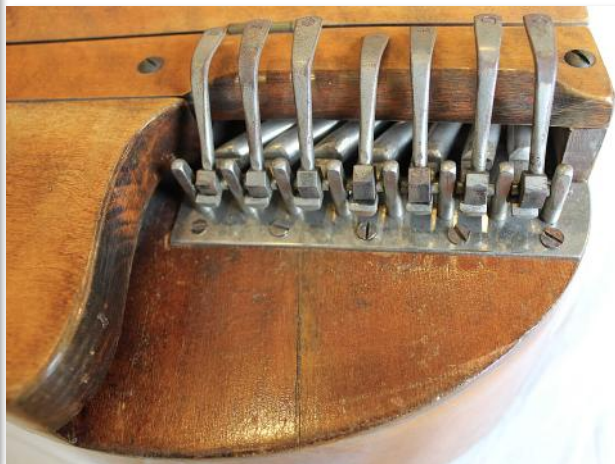
Sävelvaihtajien vivut sijaitsevat pitkän sivun ja perän kulmankesä. Tämä vastaa Salmisen toisen sävelvaihtokoneisto patentin ensimmäistä mallia.
