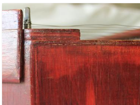
Kansi on sinujen päällä ja viritystappipenkki kannen päällä.
