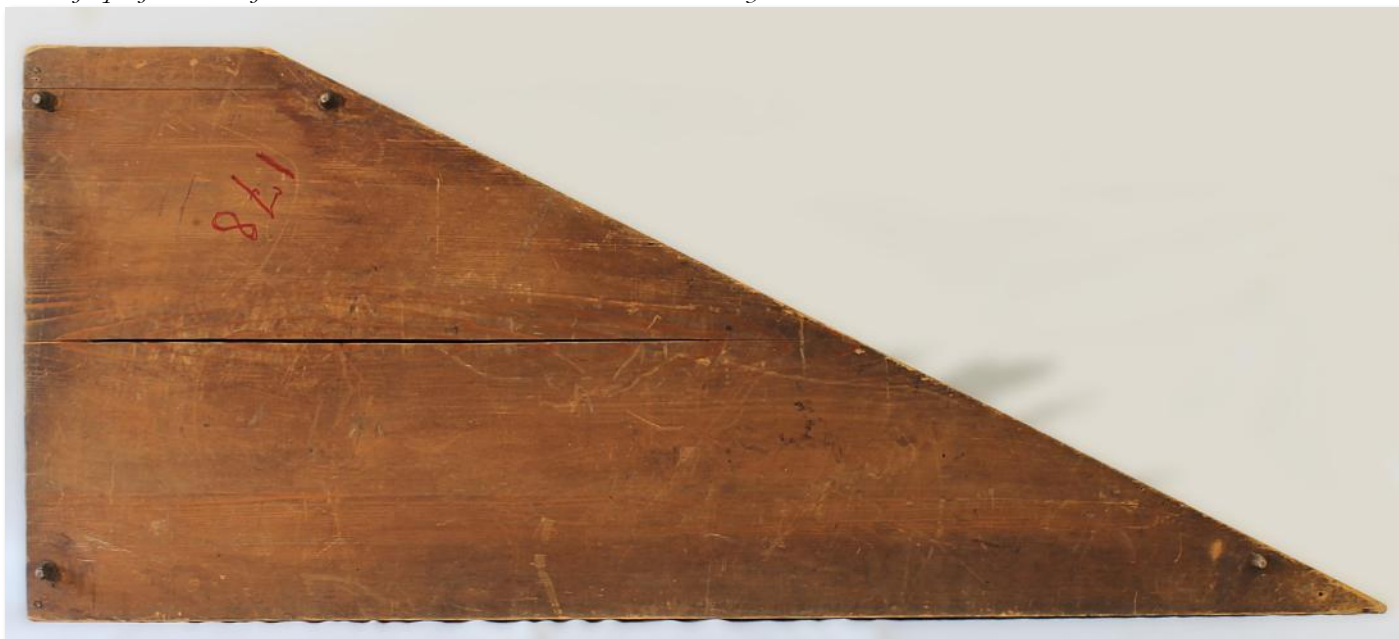
Kansi ja pohja ovat haljenneet samasta kohden. Yläkuvan raosta näkyvät kansirimat.
