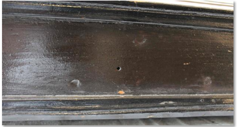
Pitkällä sivulla on pieni pyöreä reikä sunnilleen sivun puolivälissä.
